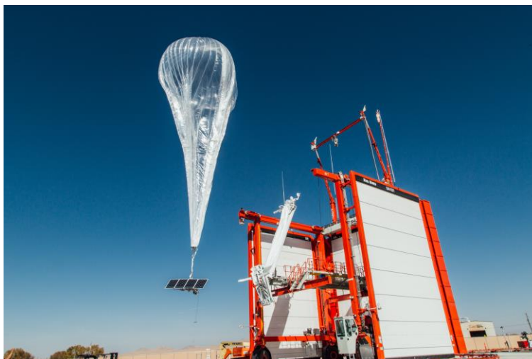
Figur 12 Loon ballon til venstre og specialudviklet autolauncher platform til højre 63
