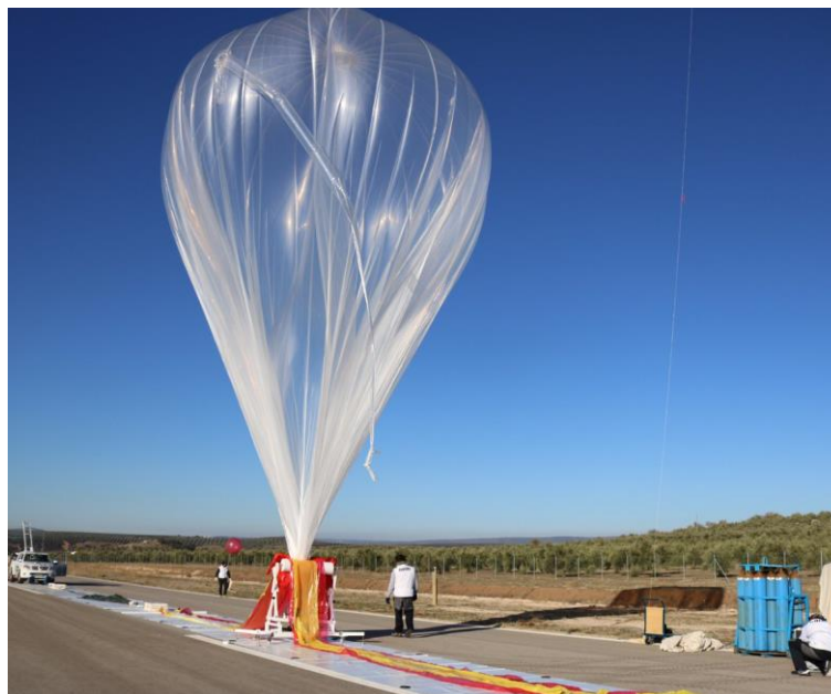
Figur 13 Opsendelse af en Elevate i 2017, bærende 135 kg udstyr for Airbus 65
